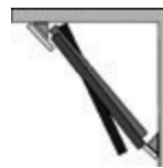
Figur 4: Eksempel på skråabsorbent
